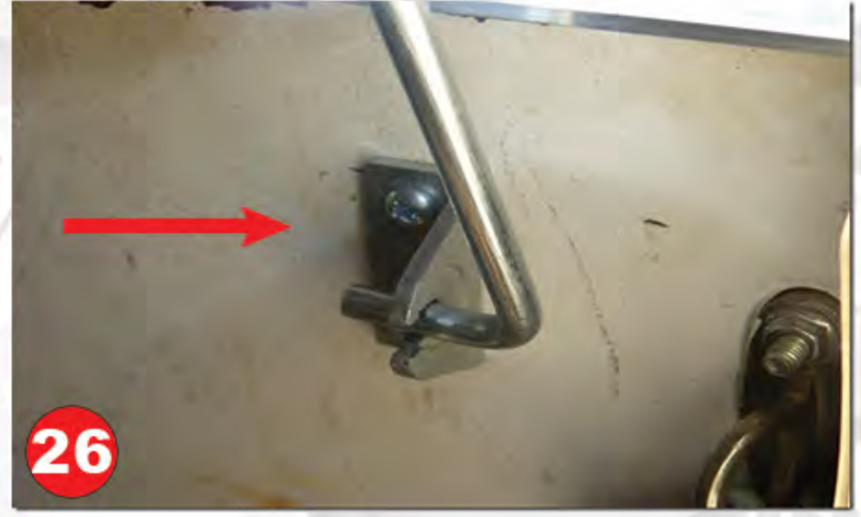
Montage de l'équerre sur la porte arrière
