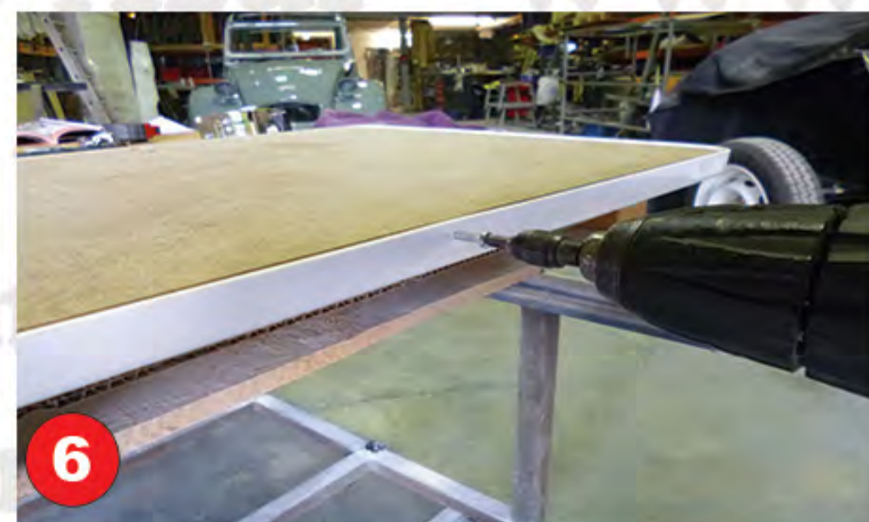
6 Fixer l'ensemble avec 4 Vis, puis retourner le Kit
