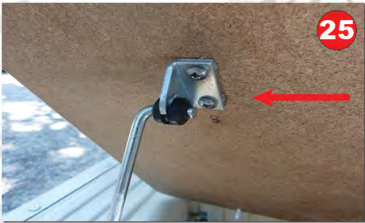
Montage de la béquille de coffre sur la planche
