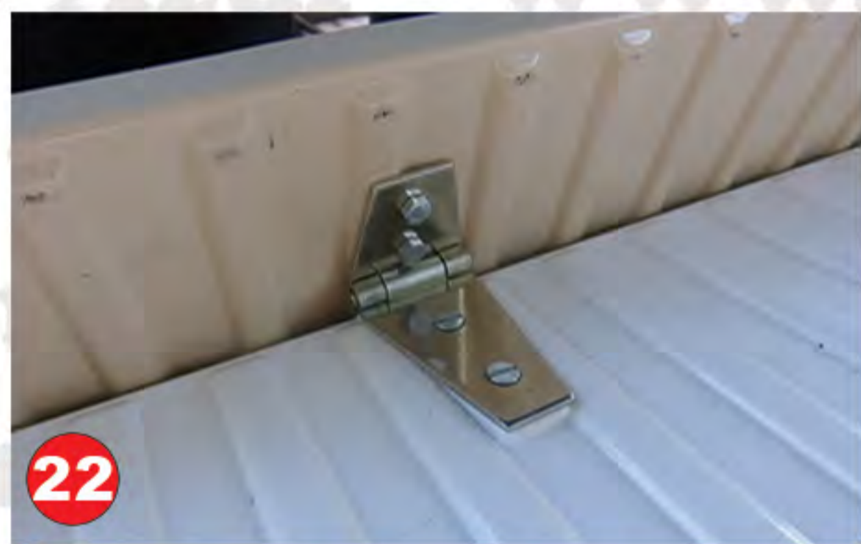
Montage du coffre sur la planche sur siège arrière
