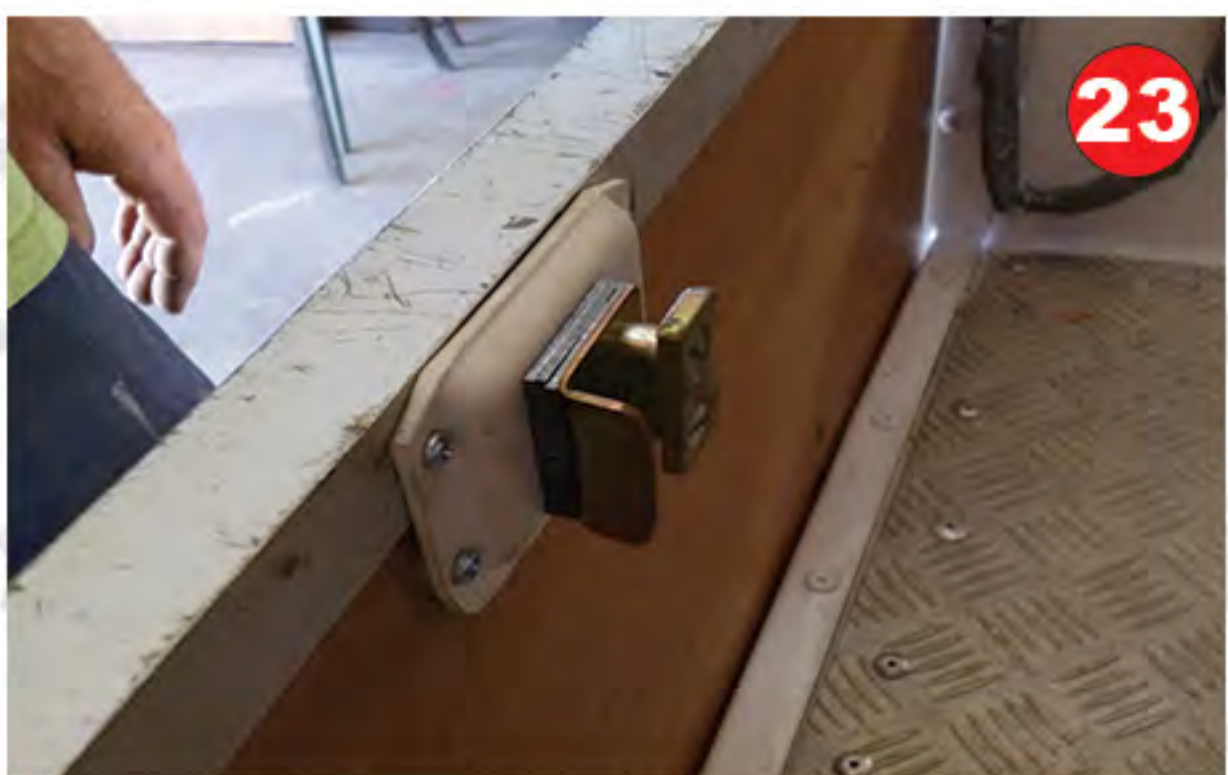
Assemblage de la gache de serrure sur la planche de la porte arrière
