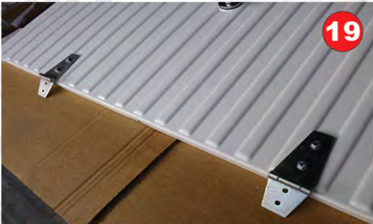
Mettre en place les 2 charnières (4Vis TH 6x35 + 8 Rondelles + 4 écrous frein)
