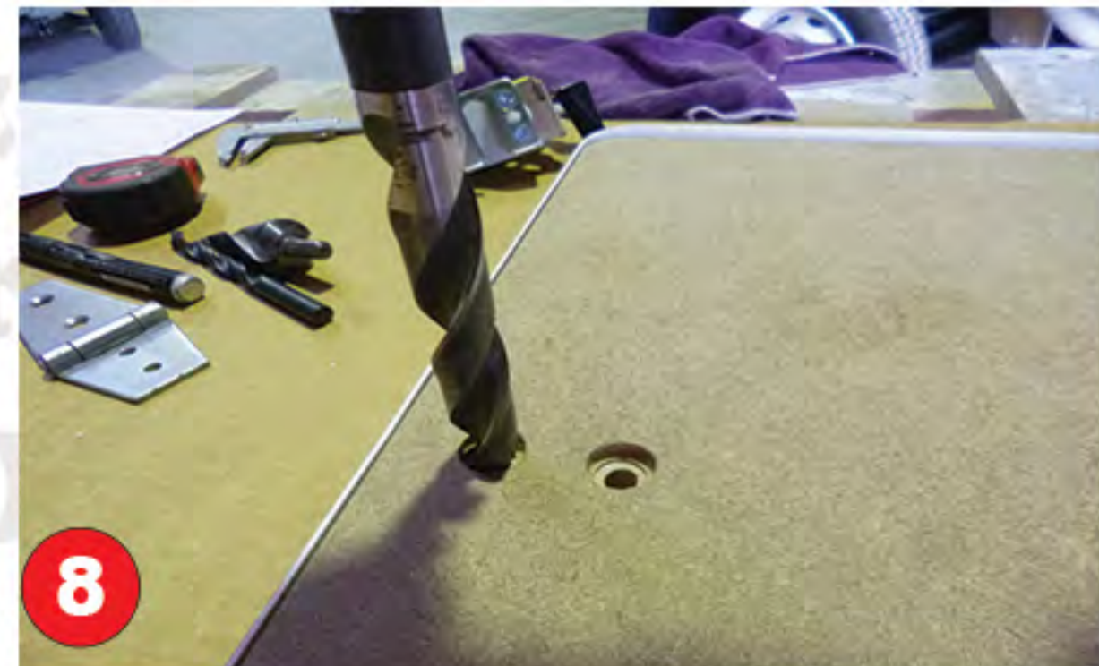
8 Faire un épaulement de 5 à 7 mm de profondeur avec un foret ou une fraise diamètre 17 mm
