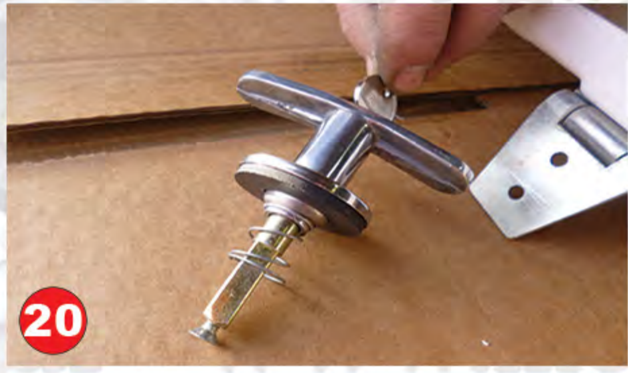
Assembler le Kit poignée extérieure avec la serrure
