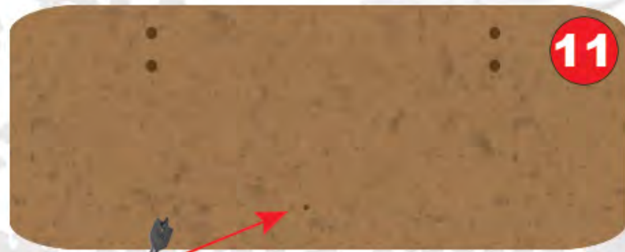
9 Perçage de part en part avec un foret diamètre 5 mm au centre
