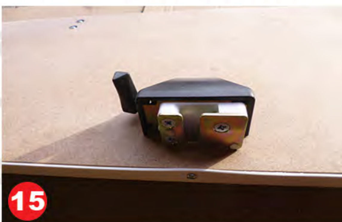
15 Fixation de la serrure avec le 3 vis TF 8x25 + rondelles + écrous.
